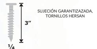
Para la instalación de la boya por medio del sistema de sujeción de clavos se debe utilizar clavos de ¼ x 3\"/>
