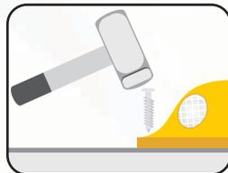
Para una sujeción excelente coloque 4 clavos de  $\frac{1}{4}$  X 3.
