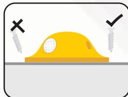
Coloque el clavo en el ojillo correspondiente para evitar perforaciones extras de  $\frac{1}{4}$ " X 3.
