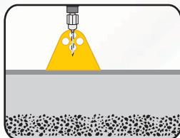
Colocar la pieza y sobre orificios del delineador perforar con taladro y broca para concreto de ½ x 10" a 11cm de profundidad (aproximada).
