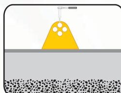
Se colocan las tuercas del taquete expansivo con dado de 3/4" extra largo, con torquímetro de ½", para poder dar el torque entre 40 y 45 lbs para la adecuada sujeción, así sucesivamente a las 4 tuercas que sujetarán al delineador.
