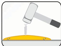
Ya perforado se clava un perno estriado de ¼ X 3" con un martillo de 16 libras hasta llegar al ras del botón óptico para garantizar una sujeción excelente.
