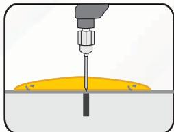
Limpiar el área donde se va a colocar la pieza. Perforar en el centro con broca de concreto ¼" X 6" (2.5 cm).
